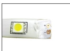
2. Rimozione silicone dai pads
